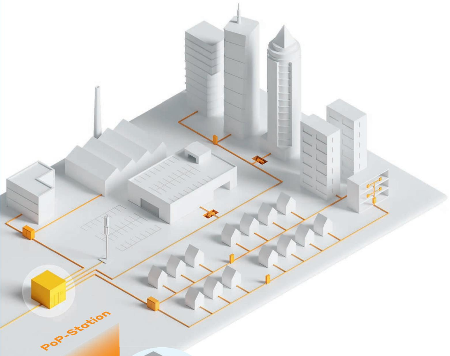
Eine PoP-Station\* ist eine Technikzentrale und stellt das Herzstück in der kommunalen Breitband-Infrastruktur dar: In ihr werden die Verbindungen für Daten- und Sprachverkehr zusammengeführt. Die PoP-Station fungiert als Knotenpunkt zwischen dem Weitverkehrsnetz (WAN = Wide Area Network) und dem regionalen FTTH-Glasfasernetz, welches bis zu jedem einzelnen Hausanschluss führt.
