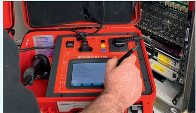
Prüfung des MFG nach DIN VDE 0701-0702:2008-06
