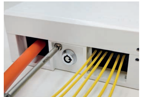
8D ARCA S zusätzlich mit Spezialschraube Sichern. Werkzeug: Torx mit Loch TX20
