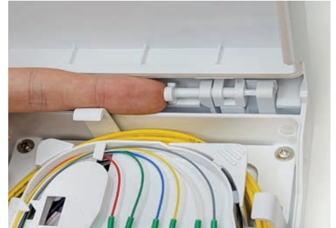
8A Deckel durch Einschieben der Befestigungsstifte montieren.
